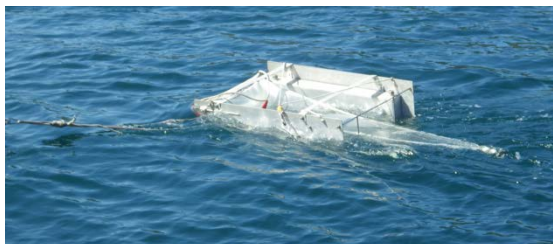
図5 豊潮丸で曳航した ORI ニューストーンネット。
