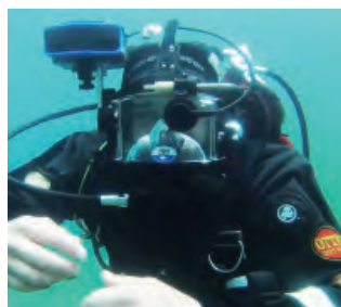
DMDダイバーマウントディスプレイ 視界ゼロ水域においても ダイバーがナビゲート可能
