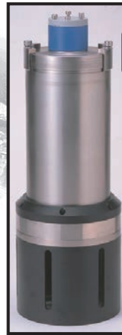
水質総合監視装置
