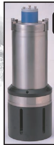
水質総合監視装置
