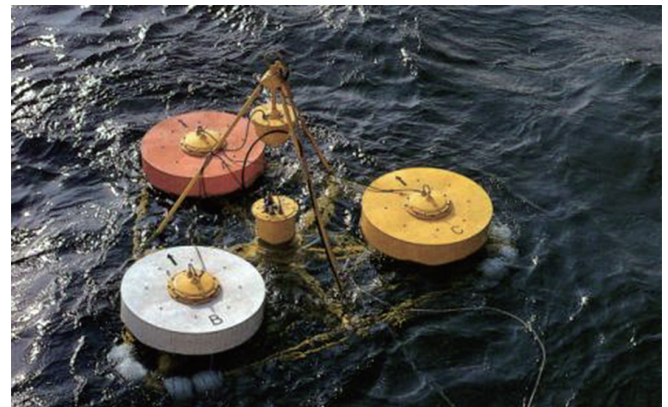
日本のクローバーブイ(円盤の直径1m)、フランスのピッチ・ロールブイ、カナダのピッチ・ロールブイ
