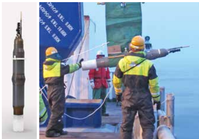
図1：Deep NINJAの外観と海洋地球研究船「みらい」による投入の様子（提供：海洋研究開発機構）
