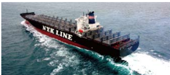
図1. NYK TERRAの全容(積荷がない状態)。約76,000トン、船速は最大25knot程度、フロート投入を行う舷の高さは約10m。(写真提供:日本郵船株式会社)
