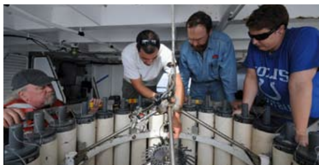
図1 キャプション：ニスキン採水器を調整している様子。Kostel氏（ウッズホール海洋研究所）提供
