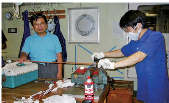
KH03-01 研究航海でヘリウム同位体比分析用の海水試料を銅管に封入している様子 (左が佐野先生)
