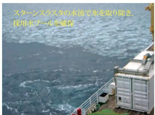
写真10 船体移動により採水用プール確保と船体固着防止(協力: JAMSTEC)
